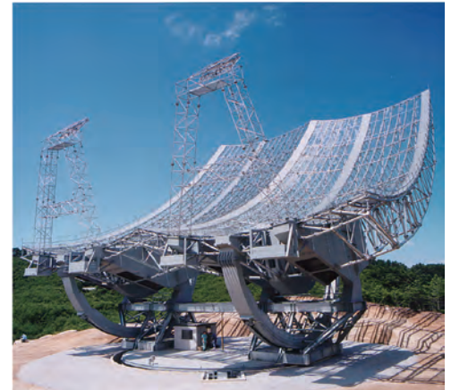
図1. 福島県相馬郡飯館村の東北大学惑星圏観測所に設置されている経緯台式大型電波望遠鏡 IPRTの写真。アンテナ開口は33m×31mある。
