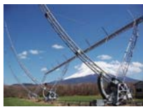
富士近郊で稼働中の惑星空間シンチレーション観測用の電波望遠鏡
