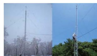
電離層侵入電場を観測する、世界4地点に展開するFM-CWレーダー
